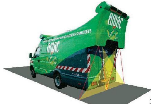
Figure 1. Dispositif d'acquisition d'images de surfaces de chaussées.
