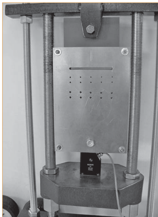
▲ Photo 1 – Outil de mesure de la résistance au cisaillement des fibres végétales.
