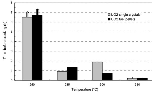
Figure 6: Périodes d'incubation avant fissuration de monocristaux et de fragments de pastilles de combustible de  $UO_2$  oxydés in-situ au MEB Environnemental sous  $O_2(g)$  ( $P_{O_2}=267 Pa$ ) et à différentes températures.
