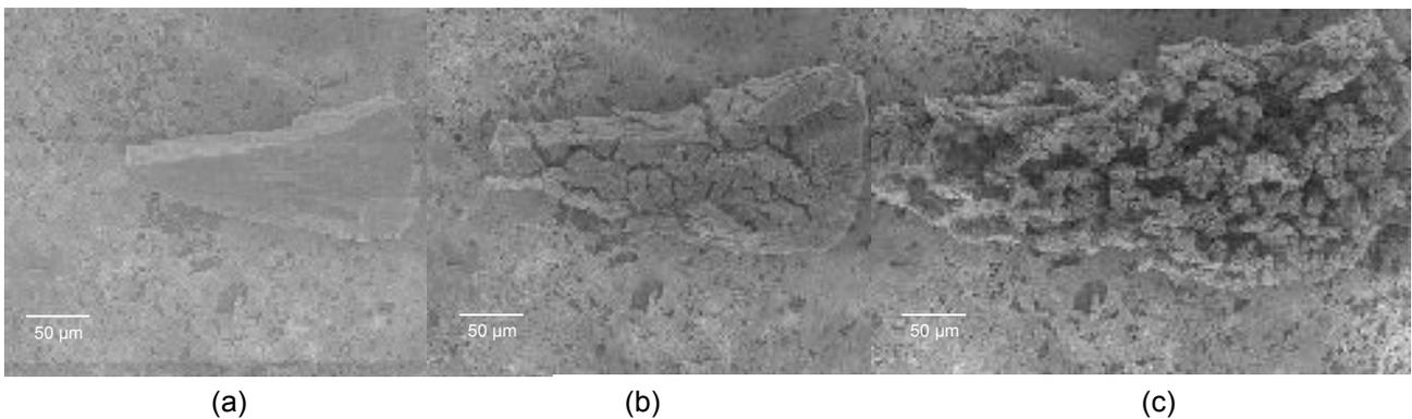
Figure 4: Fragmentation d'un fragment de pastille de combustible de  $UO_2$  oxydé in-situ au MEB Environnemental à  $330^\circ C$  sous  $P_{O_2} = 267 Pa$ : (a) état initial, (b) après 1,5 h d'oxydation et (c) état final après 5,5 h d'oxydation.
