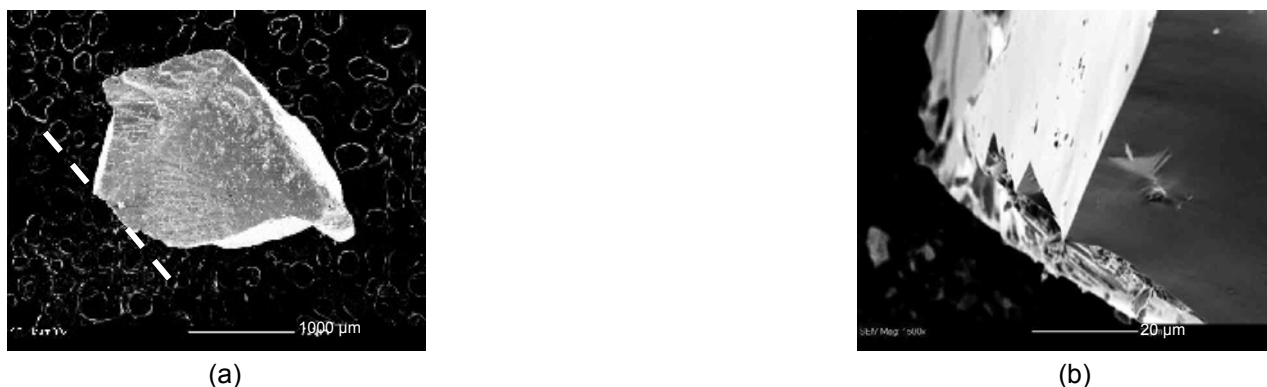
Figure 1: Micrographies MEB montrant la fragmentation d'un monocristal de UO_2 oxydé ex-situ à 250^\circ C pendant 16 h dans un mélange He/O_2 (80/20) à 2 L.h^{-1} : (a) état final et (b) zone de fracture.
