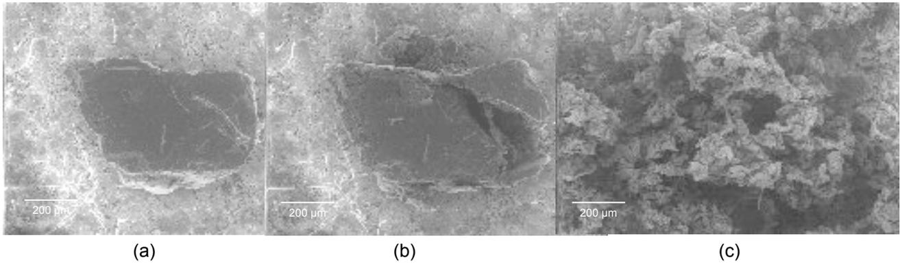
Figure 3: Fragmentation d'un monocrystal de  $UO_2$  oxydé in-situ au MEB Environnemental à  $330^\circ C$  sous  $P_{O_2} = 267 Pa$ : (a) état initial, (b) après 1 h d'oxydation et (c) état final après 5,6 h d'oxydation.
