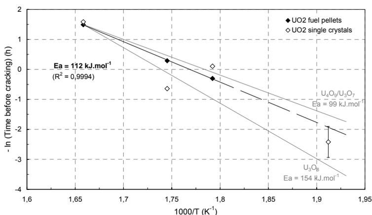
Figure 8: Détermination de l'énergie d'activation associée à la période d'incubation avant fissuration des fragments de pastilles de combustible de  $\text{UO}_2$  oxydés in-situ au MEB Environnemental entre 250 et 330°C, sous  $\text{O}_2(\text{g})$  ( $P_{\text{O}_2} = 267 \text{ Pa}$ ).
