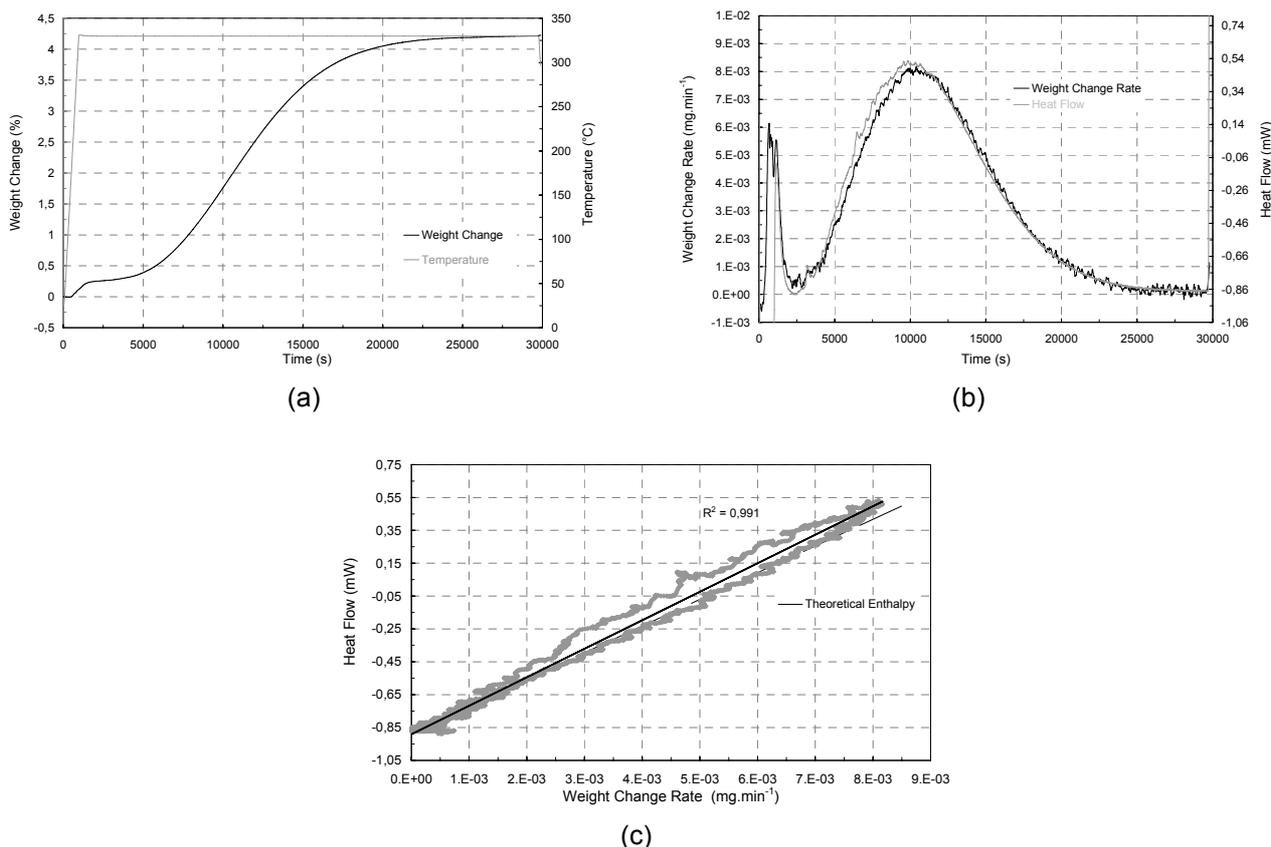
Figure 2: Oxidation isotherme d'un monocristal de  $UO_2$  non irradié à  $330^\circ C$  sous  $P_{O_2} = 267 Pa$  pendant 8 h dans un mélange  $He/O_2 (g)$  (80/20) à  $2 L.h^{-1}$ : (a) Variation massique après soustraction de la ligne de base, (b) Test de la stationnarité et (c) Détermination de l'enthalpie de la réaction  $UO_2 \rightleftharpoons U_3O_8$ .
