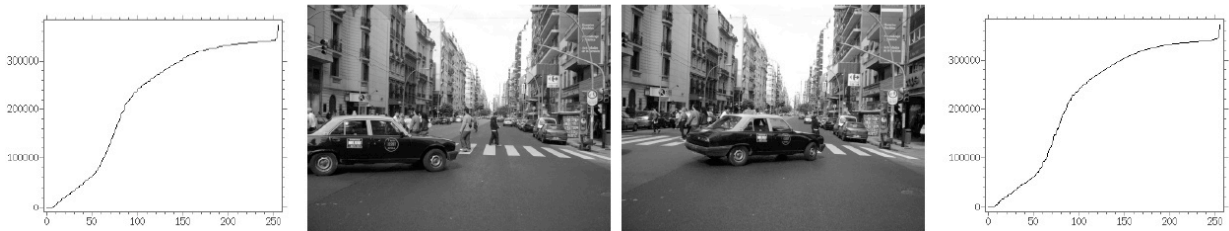
Les mêmes images qu'au-dessus après égalisation mi-chemin (midway) et leurs histogrammes cumulés.
