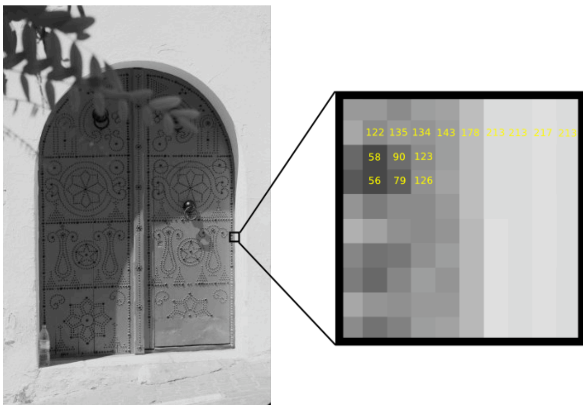
A gauche, une image numérique qui contient 486 \times 324 pixels. A droite, un extrait de l'image, de taille 10 \times 10 pixels, avec quelques-uns de ces niveaux de gris indiqués en jaune.
