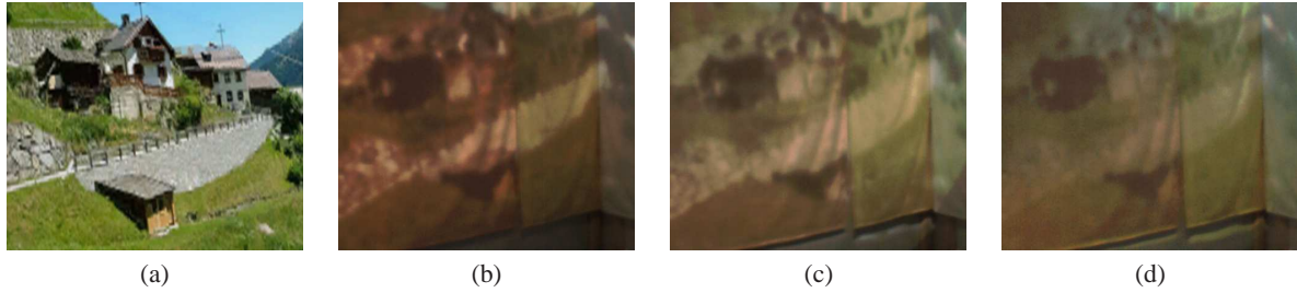
Figure 10: Résultats de la compensation radiométrique de la projection. Simulation de l'environnement souhaité (a), photo de l'environnement vu par l'utilisateur sans compensation (b) (erreur = 0.023), avec compensation des premières réflexions (c) (erreur = 0.019) et avec compensation complète (d) (erreur = 0.015).
