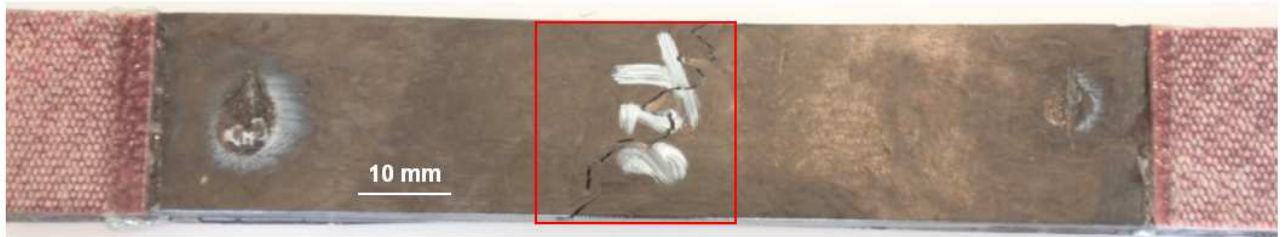
Fig. 9. Faciès de rupture d’une éprouvette rectangulaire après essai de traction
