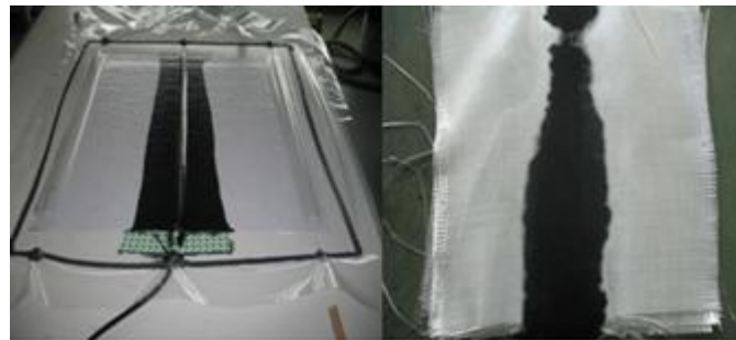
Figure 7 : Fabrication des nanocomposites par infusion.
