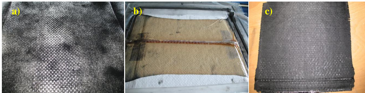
Fig. 4. a),b) Technique de poudrage en infusion, c) nanocomposite chargé en noir de carbone
