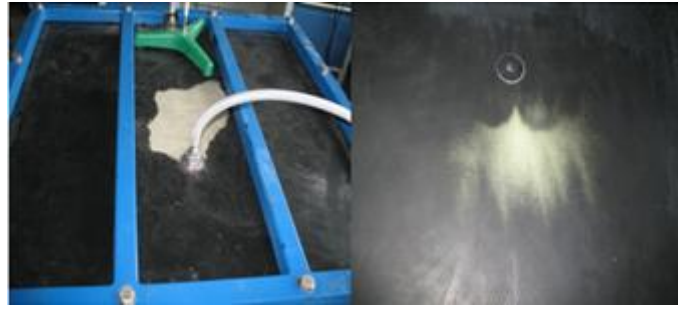
Figure 8 : Fabrication des nanocomposites par injection VARTM
