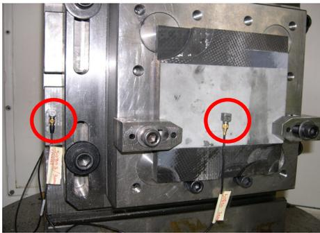
Fig. 1. Montage d'usinage et positionnement des accéléromètres
