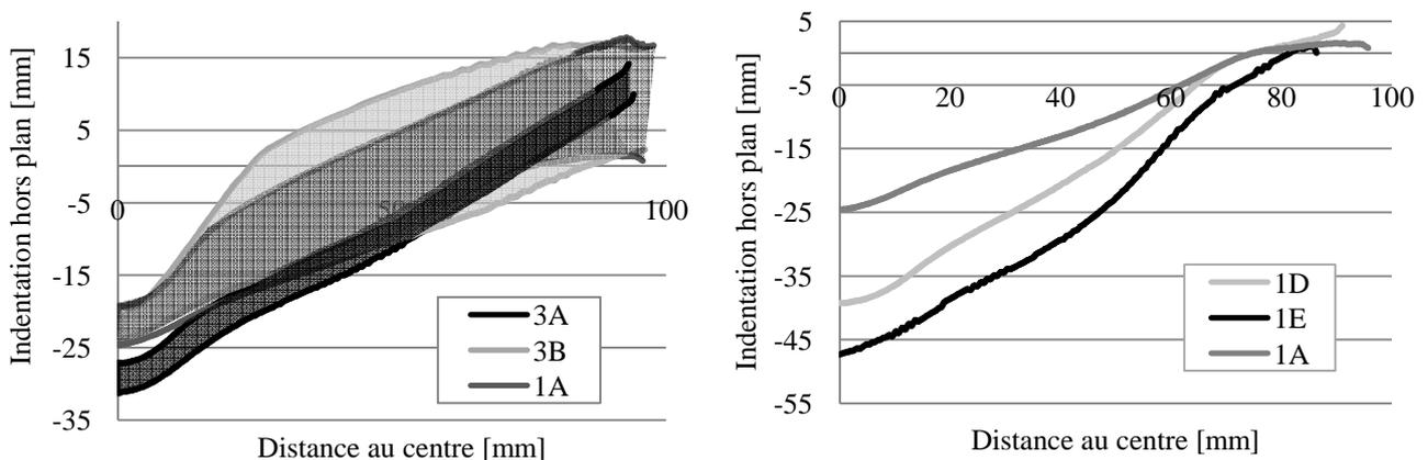
Fig. 10. Comparaison des profils après impact – a) Profil des sandwichs b) Profils des peaux arrières
