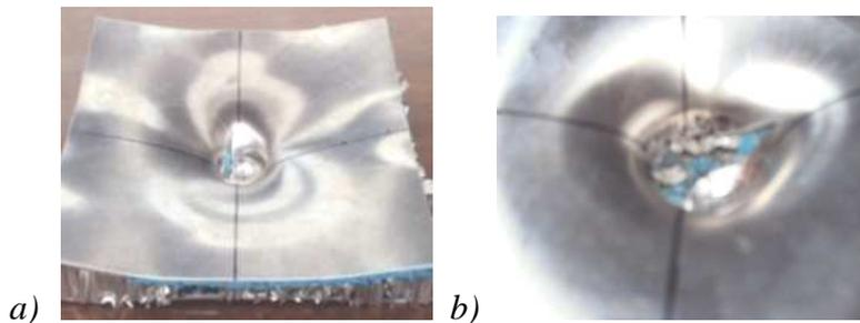
Fig. 6. Eprouvettes après impact - 2B : a) face avant (énergie basse); b) zoom face avant
