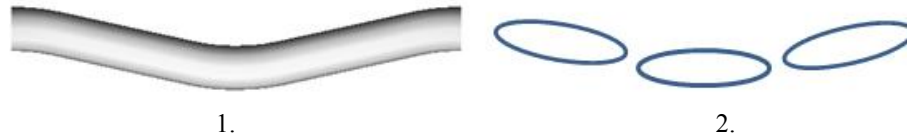
Fig. 1. 1. Fibre textile dans un composite tissé ou tressé. 2. Chacune des fibres dans le composite est remplacée par une série d'inclusions équivalentes, qui ont le rapport de forme et l'orientation de la fibre à la position de l'inclusion. Le composite devient un assemblage d'une matrice dans laquelle baignent plusieurs inclusions ellipsoïdales.
