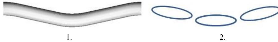
Fig. 1. 1. Fibre textile dans un composite tissé ou tressé. 2. Chacune des fibres dans le composite est remplacée par une série d'inclusions équivalentes, qui ont le rapport de forme et l'orientation de la fibre à la position de l'inclusion. Le composite devient un assemblage d'une matrice dans laquelle baignent plusieurs inclusions ellipsoïdales.
