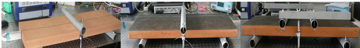
Fig. 4. Essai de flexion statique à trois et quatre points
