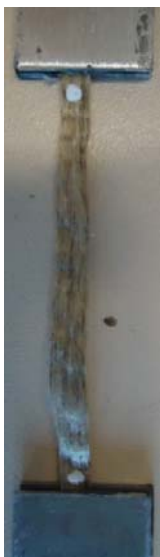
Fig 7. (a) Echantillon mèche pour l'essai de traction. (b) Comportement en traction.
