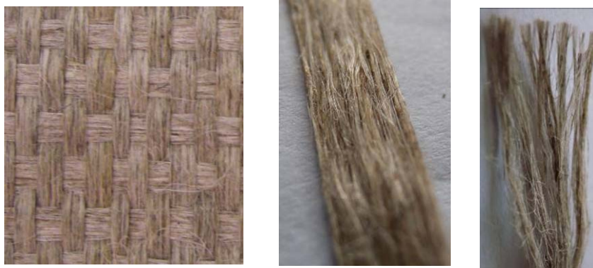
Fig 2. (a) Renfort tissé de lin (b) Mèches. (c) Constitution des mèches
