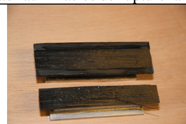
(d) matériau C faciès de rupture à 45° et +
