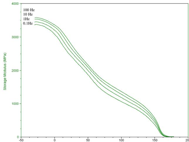
Fig.4 . Evolution du module de conservation mesurée par DMA pour le composite lin blanchi/PP neuf\_1600g/m<sup>2</sup>
