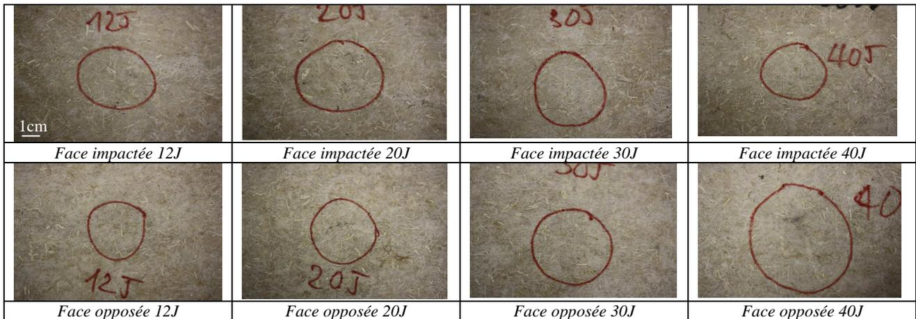
Fig.15. Observation des surfaces sur la face impactée et sur la face opposée - lin blanchi/PP neuf\_1600g/m<sup>2</sup>
