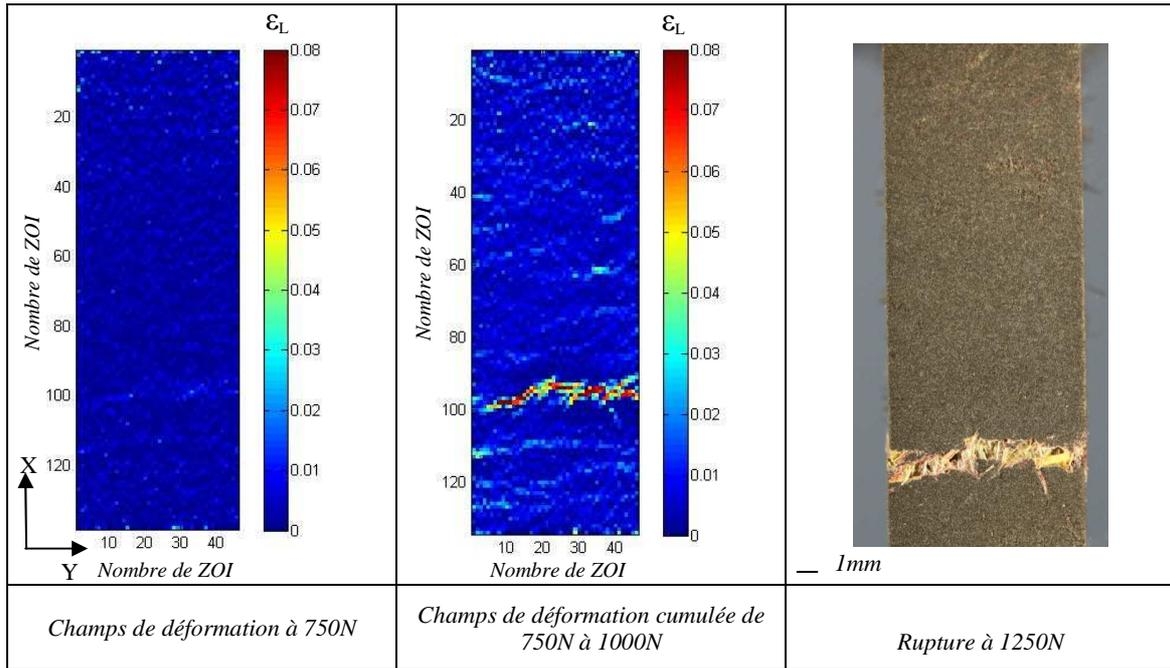
Fig.10. Champs de déformation longitudinale  $\epsilon_L$  et la rupture finale d'une éprouvette en lin écru/PP recyclé\_1600g/m<sup>2</sup>
