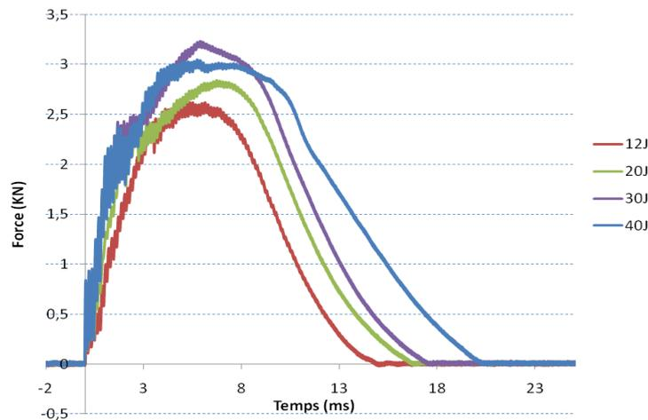
Fig. 2. Evolution de la force d'impact sur le lin blanchi/PP neuf\_1600g/m<sup>2</sup>
