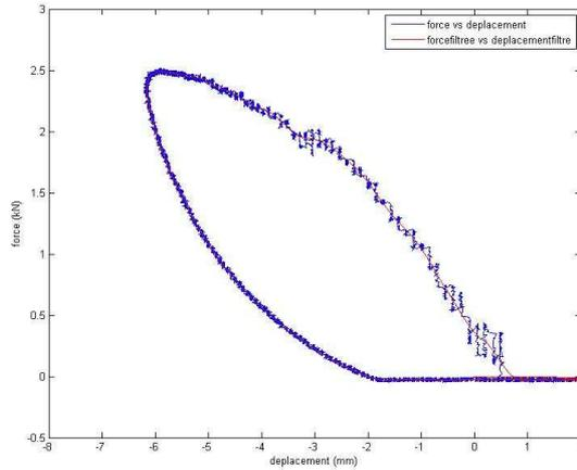
Fig.12. Evolution de la force en fonction de déplacement sur un échantillon de lin blanchi/PP neuf\_1600g/m<sup>2</sup> impacté à 12J
