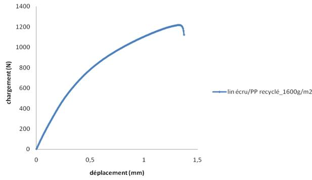
Fig.9. Comportement en traction de l'éprouvette lin écru/PP recyclé\_1600g/m<sup>2</sup> avec la prise de photos de corrélation d'images
