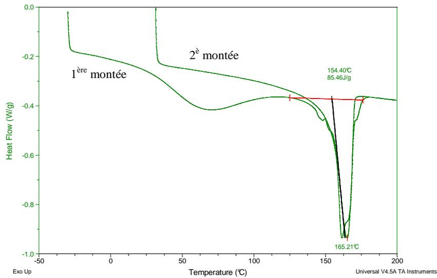
Fig.3. Analyse DSC sur le composite de lin blanchi/PP neuf\_1600g/m<sup>2</sup>
