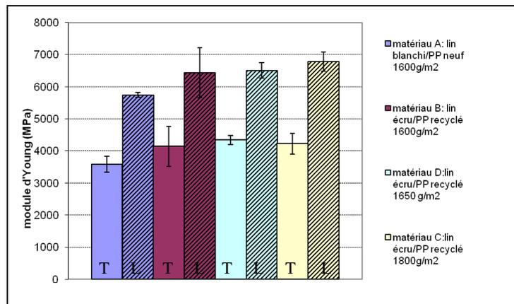
Fig .6. Evolution du module d'Young en traction simple (V=2mm/min) dans les directions L et T.
