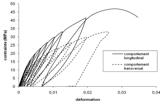
Fig .7. Comportement en traction cyclique du lin blanchi/PP neuf\_1600g/m<sup>2</sup>
