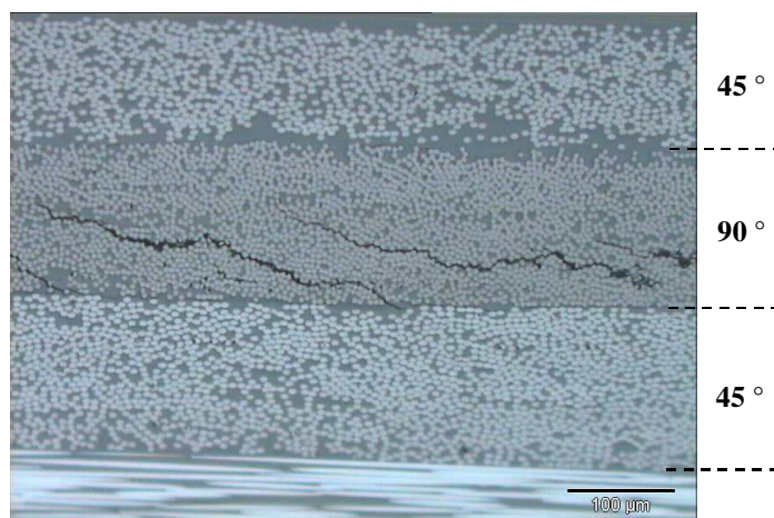
Fig. 1. Evidence d'endommagement dans des plaques composites soumises à un cyclage hygrothermique [15].
