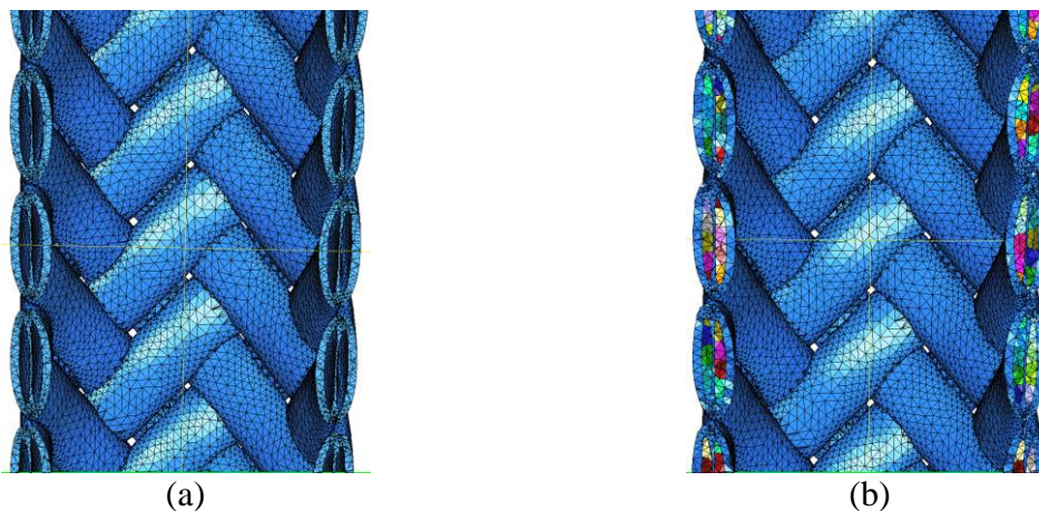
Fig. 13. (a) Maillage 3d de la matrice et (b) du tube complet.
