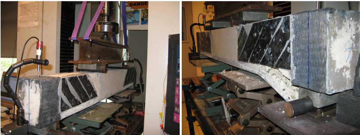
Figure 4 : Essai flexion 4 points sur une poutre BA renforcée avant et après la rupture par peeling-off
