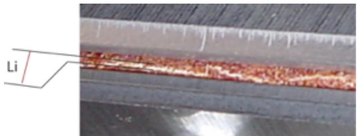
Fig. 20 : Formation d'un pli à l'échelle du papier
