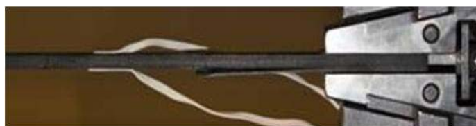
Fig. 7. Décollement des plis de recouvrement inférieurs durant un essai de traction.
