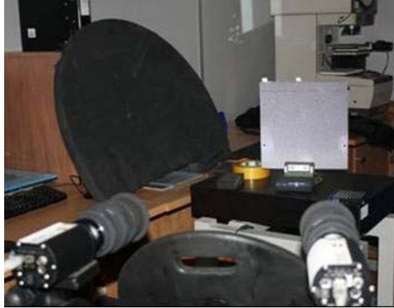
Fig. 3. Mesures géométriques par stéréovision entre chaque phase d'usinage.
