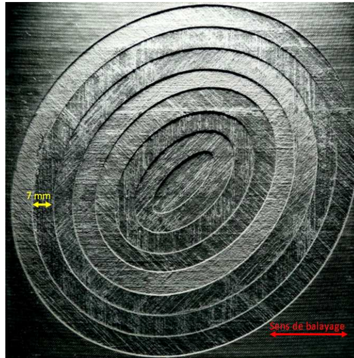
Fig. 11. Photo d'un usinage de réparation en escalier sur 8 plis de profondeur réalisé par JEA dans un composite en carbone époxy.
