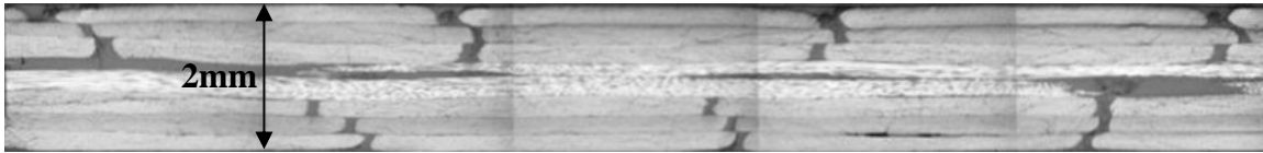
Fig. 3. Morphologie hétérogène du matériau (QI) – Plan d'observation passant par trous de couture.
