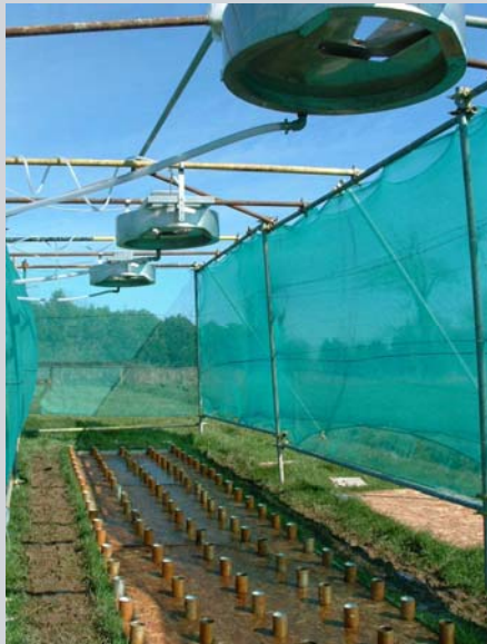
Premières lixiviations, grâce à un simulateur de pluie
