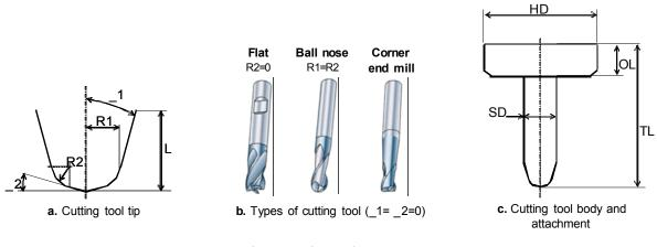
Fig. 9. Cutting tool parameters
