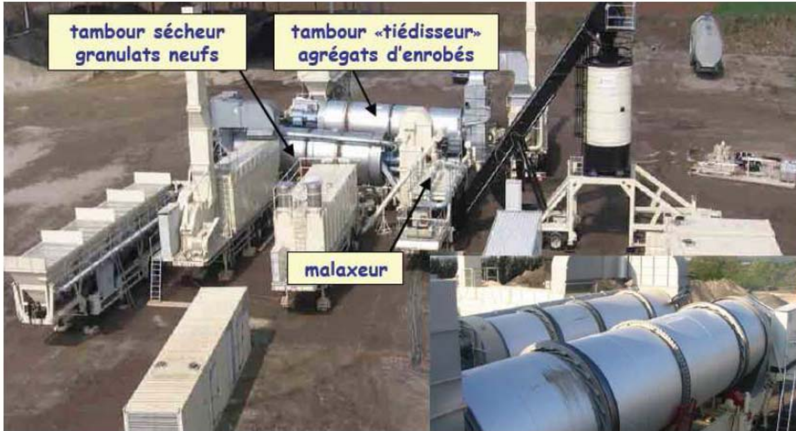
Photographie d'une centrale HPR (Haut Pouvoir de Recyclage)
