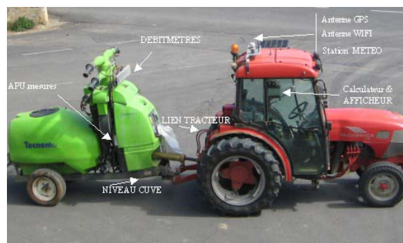
Figure 2 : l'équipement tracteur - pulvérisateur, La MPU tracteur ( photo Cemagref)
