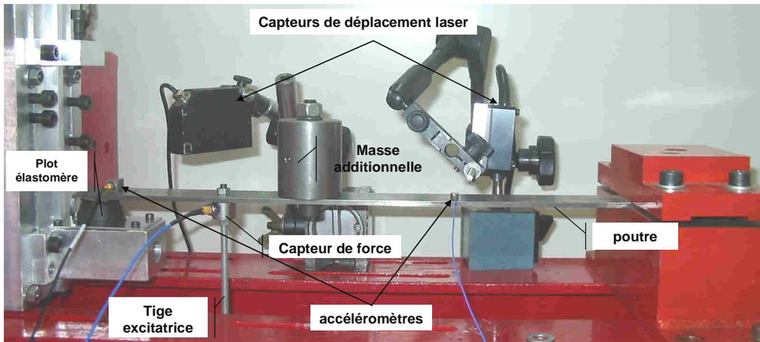
FIG. 9: Structure simplifiée support de la validation.
