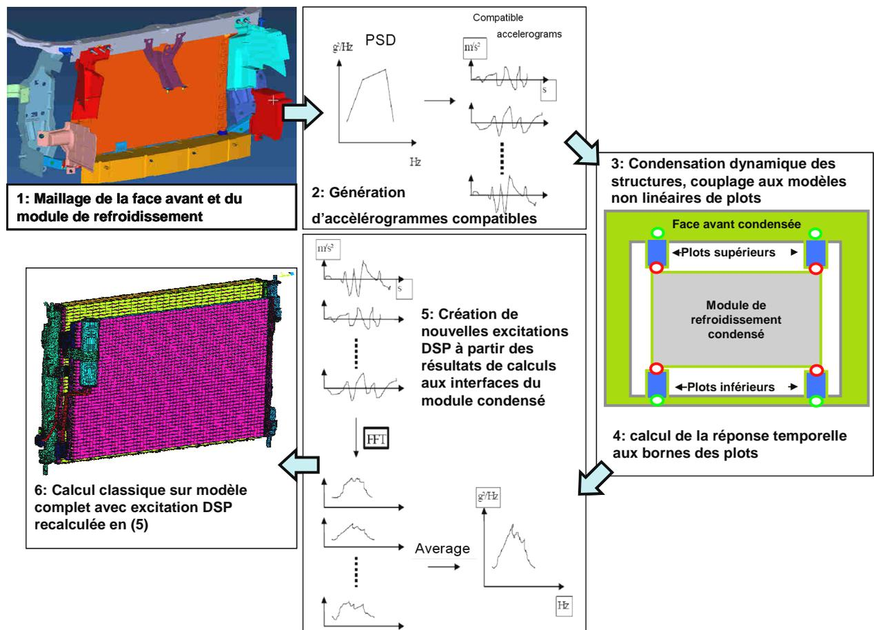
FIG. 2: Schéma du processus de simulation proposé
