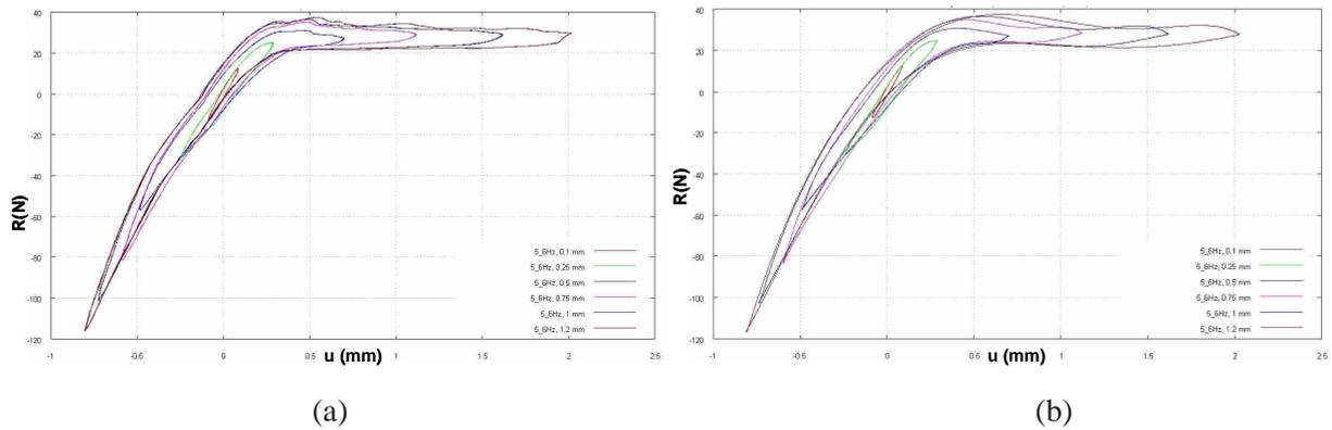
FIG. 7: Comparaison entre cycles force – déflexion  $(R(t), u(t))$  mesurés (a) et simulés (b)
