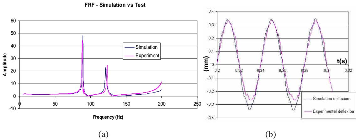
FIG. 11: (a) FRF calculée et mesurée au nœud 8 (accéléromètre), (b) déplacement calculé et mesuré au nœud 9 (laser).
