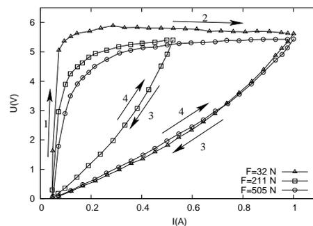
FIGURE 1 – Caractéristiques U-I dans une chaîne de billes [2].
