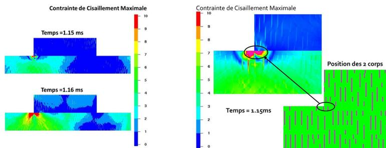
FIG. 8 – a) Localisation des contraintes de cisaillement maximales dans le modèle  $1_1$  et (b) comparaison de la position des corps au champ de contrainte de cisaillement maximale à  $t = 1.15 \text{ ms}$
