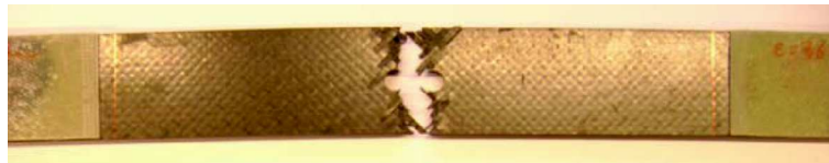
FIG. 2 – Eprouvette trouée en laminé d'empilement [(+45^\circ, 0^\circ)_3]_S après un test en traction jusqu'à rupture.
