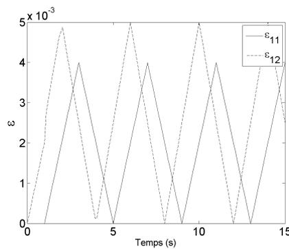
FIGURE 3 – Essai de traction-cisaillement déphasé : évolution des déformations
