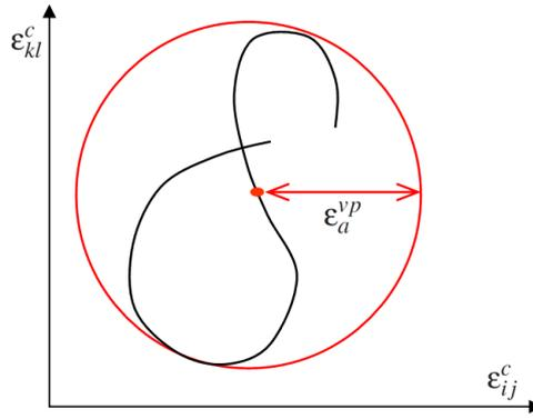
FIGURE 2 – Définition de l'amplitude de plasticité cyclique
