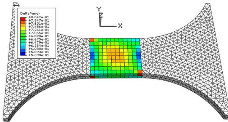
FIGURE 7 – Énergie dissipée au cours du dernier cycle
