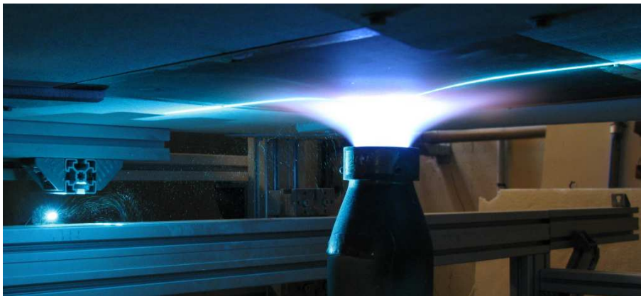
FIG. 1 – Photographie du banc Interaction flamme-paroi (ONERA Toulouse).
