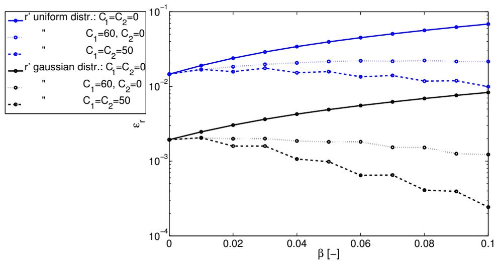
FIGURE 4 – Erreur relative dans l'approximation du noyau  $G$  pour deux distributions de nuages de points  $\mathbf{r}'$  et une distance entre cellules fixée à  $\mathbf{r}_0 = 2(k^*d)$  : influence des constantes  $C_1, C_2$ .
