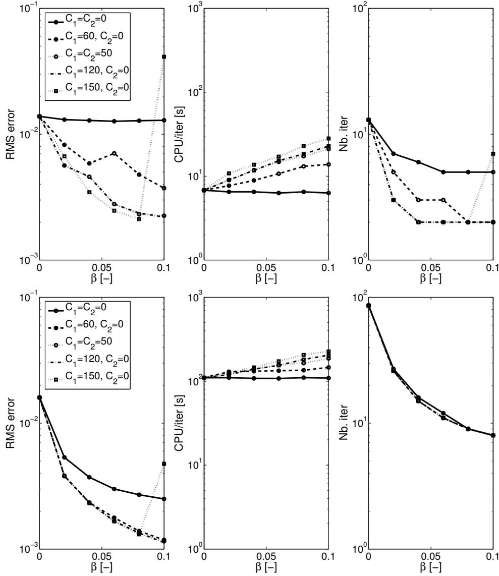
FIGURE 6 – Influence de différentes combinaisons de  $(C_1, C_2)$ , avec  $\alpha = 0.3$  : cavité sous pression (haut,  $\eta_P = 3$ ) et diffraction d’une onde incidente P verticale par une cavité sphérique (bas,  $\eta_P = 4$ ).
