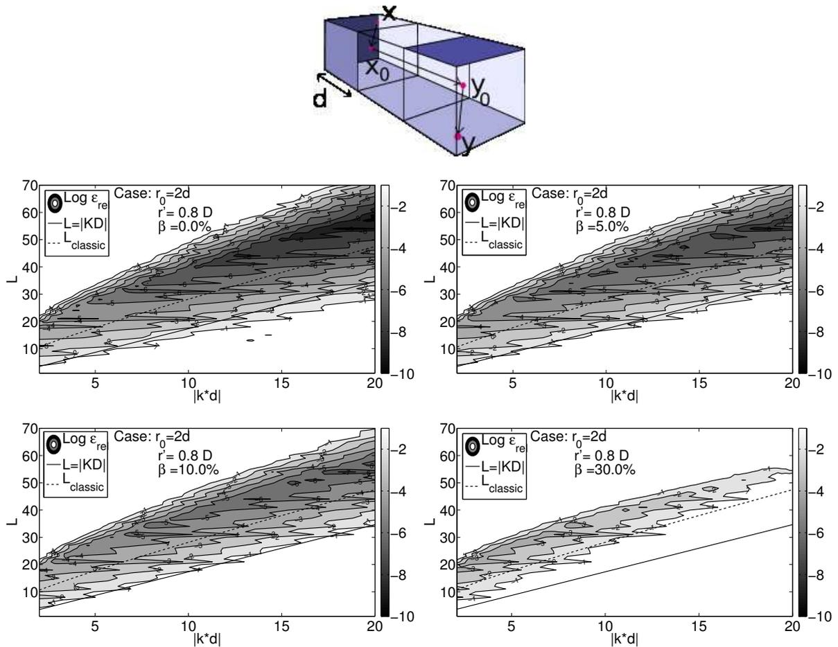
FIGURE 2 – Carte des isovaleurs de l'erreur relative  $\varepsilon_{rel} = |G_L - G_{an}|/|G_{an}|$  entre deux points fixés ( $\mathbf{r}' = 0.8D$ ) positionnés dans deux cellules les plus proches non-adjacentes : influence de l'amortissement  $\beta$ .
