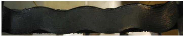
FIG. 3 – Flambement dans le plan de la nappe fibrée observé expérimentalement.
