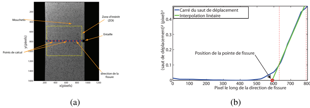
FIGURE 1 – Illustration de la définition de la zone d'intérêt sur la surface d'une éprouvette de traction entaillée (a) Extraction de la position du front de fissure à l'aide du saut de déplacement (b)
