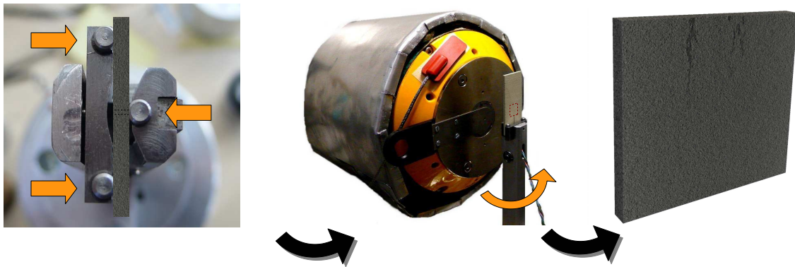
FIGURE 2 – Prototype de double-torsion in situ dans un tomographe X
