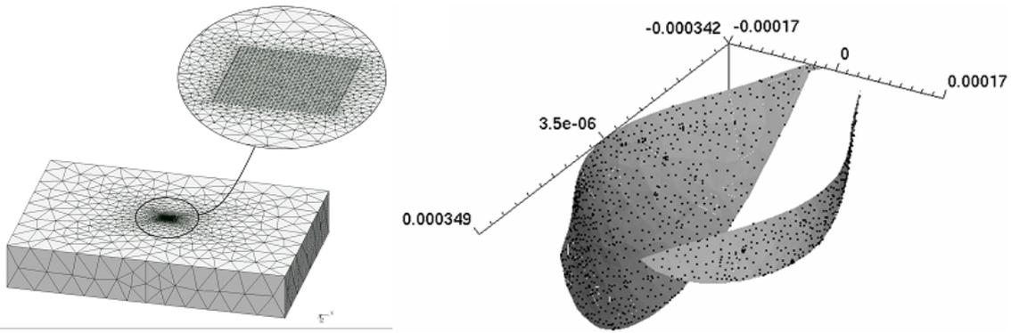
FIGURE 7 – maillage de l'éprouvette  $8 \times 5 \times 2 \text{ mm}^3$  (46266 tétraèdres) raffiné au voisinage de la zone de contact et discrétisation des éléments d'interface sur les fissures : 902 paires de points d'intégration.
