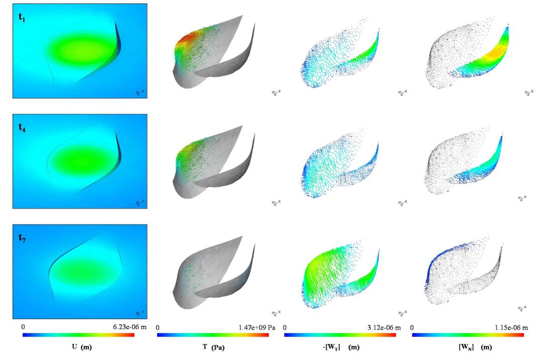
FIGURE 8 – représentation amplifiée du champ de déplacement global  $\mathbf{U}$ , chargement de contact  $\mathbf{T}$ , glissement  $-[\mathbf{W}_T]$  et ouverture  $[\mathbf{W}_N]$  entre les faces des fissures aux instants 1, 4 et 7 du cycle de fretting.
