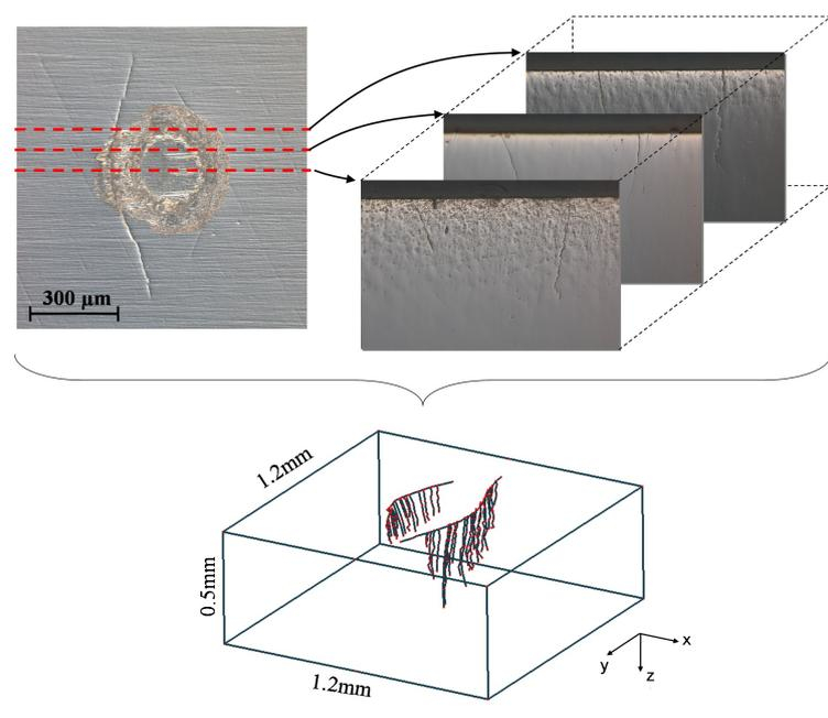
FIGURE 6 – (a) Aire de contact de fretting circulaire avec une zone de glissement annulaire (rayon  $c$ ) et deux fissures semi-elliptiques non-planes. (b) Série de coupes métallographiques du spécimen fissuré et (c) reconstruction 3D des fissures de fretting observées (La fissure 1 est la plus profonde, et la fissure 2 la plus courte).  $P=120\text{ N}$ ,  $Q_{\max}=95\text{ N}$ ,  $a=171\ \mu\text{m}$ ,  $c/a=0.52$ , coefficient de frottement sphère / plan  $\mu=0.92$
