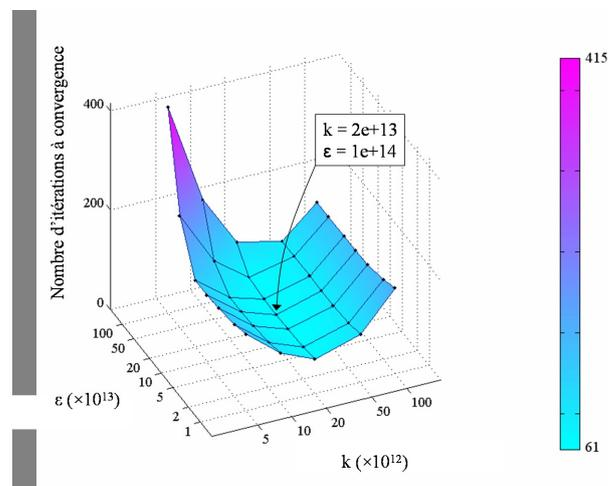
FIGURE 4 – nombre d'itérations à convergence (erreur  $\eta = 10^{-4}$  pour différentes valeurs de la direction de recherche  $k$  et le paramètre de stabilisation  $\epsilon$  en utilisant le maillage de triangles.
