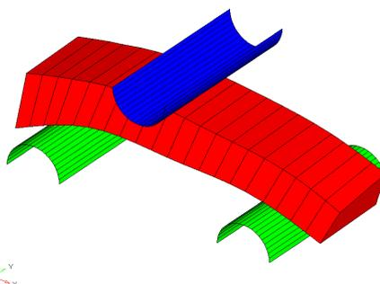
FIG. 2 – Modèle EF de l'éprouvette de l'os crânien
