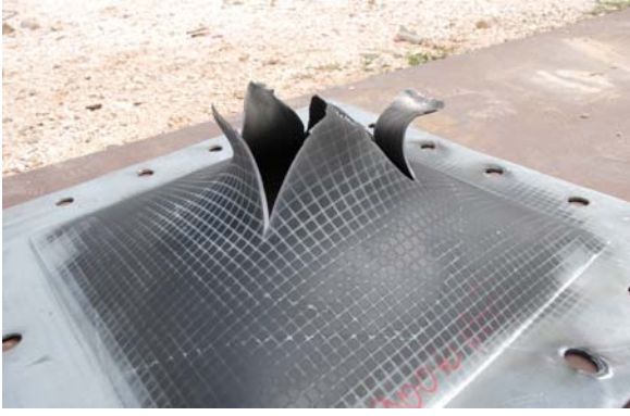
c) Déchirure en pétales ( C=2C_0 et D=D_0-5\text{mm} ).
