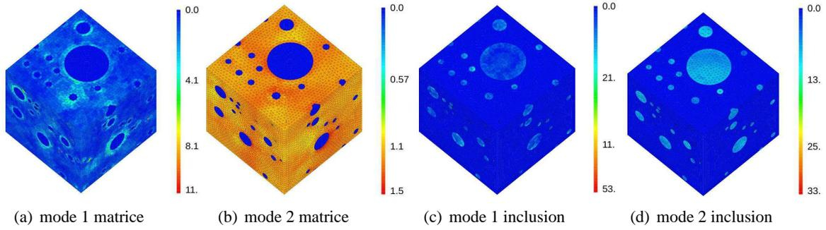
FIG. 3 – Norme équivalente du mode plastique 1 :  $\mu_{eq}^1$  - Phase Matrice & inclusionnaire - Trajet de chargement  $\underline{\underline{\Sigma}}_0^1$
