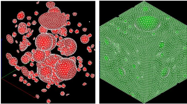
(a) Maillage des inclusions - 121 particules plutonifères 15% - fuseau diamétral des inclusions ( $10\mu\text{m}$ ,  $70\mu\text{m}$ ) (b) Maillage Matrice incluant l'enrobage et les amas uranifères
