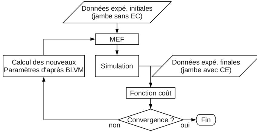
FIG. 3: Algorithme d'optimisation par une méthode inverse.
