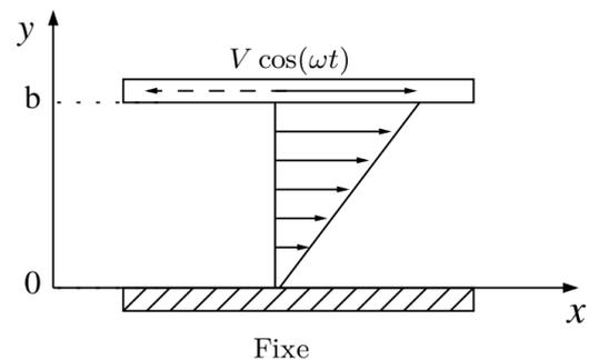
FIGURE 7 – Modèle d'écoulement laminaire à l'intérieur de la goutte.
