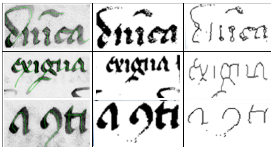
Figure 2-Tableau de comparaison des trois méthodes, notre Méthode (Colonne 1), Binarization « Sauvola »(colonne 2), squelettisation « Zhang »(colonne 3)
