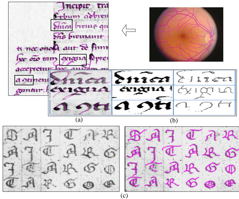
Figure 6. (a) Extraction de l'axe médian par notre méthode sans binarisation, (b) binarisation par la méthode de Sauvola et extraction de l'axe médian par la méthode de Zhang., (c) résultat de notre méthode sur un manuscrit dégradé (encre claire, bruit, trait effacé).
