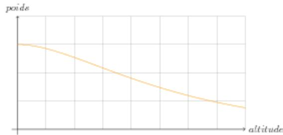
Pour calculer l'énergie que l'on dépensera pour un tel vol, il faut calculer l'aire comprise entre l'axe horizontal et la courbe depuis l'altitude 0 jusqu'à l'altitude finale, par exemple quelques centaines de kilomètres pour lancer un satellite en orbite basse. Il nous faut donc déterminer l'aire de la zone hachurée en orange dans la figure 5.
