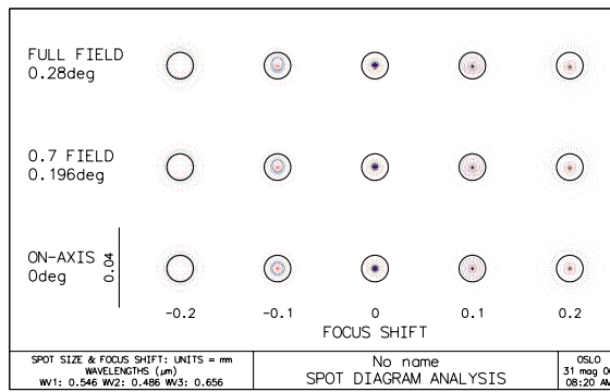
Fig. 13. Spot diagram f/2.5 .
