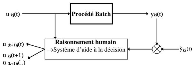
**Figure 6. Contrôle d'un procédé type batch en utilisant un contrôle batch à batch et/ou un contrôle feedback**
