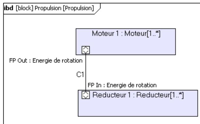
Figure 4: Exemple d'Internal Block Diagram
