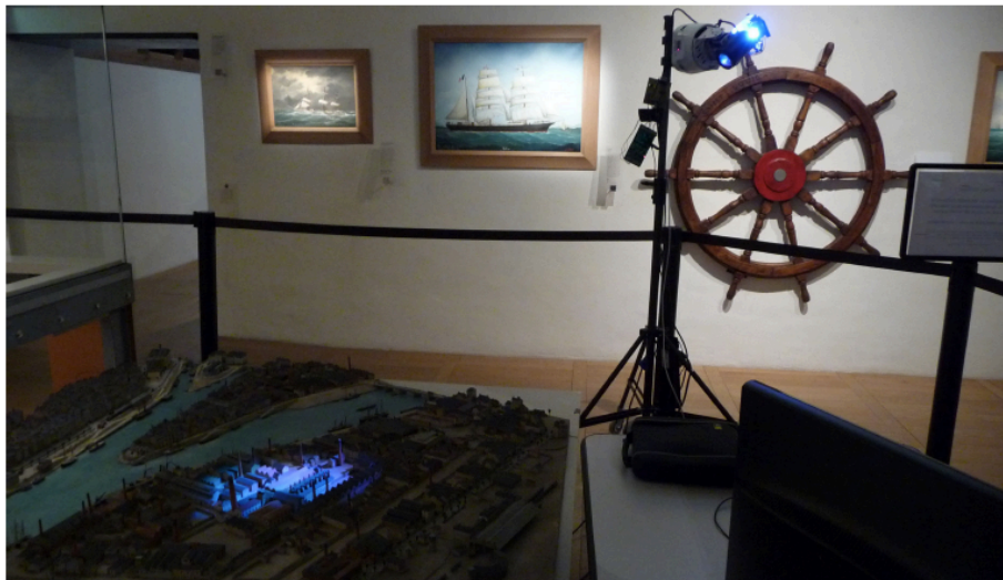
Figure 9 : « Le démonstrateur en action ! » : la maquette physique en bas à gauche est éclairée par le pointeur positionné en haut à droite de la photo ; le pointeur est directement piloté par la dalle tactile
