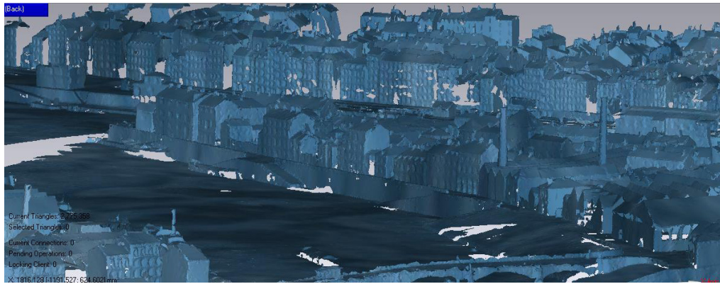
Figure 5 : Photo du nuage de points issue de la numérisation 3D de la maquette physique
